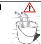
Per installatore: Al fine di garantire la durata del prodotto installare rubinetti con filtro da pulire periodicamente. Effettuare risciacquo delle tubazioni prima di installare il prodotto (PUNTO 1)
